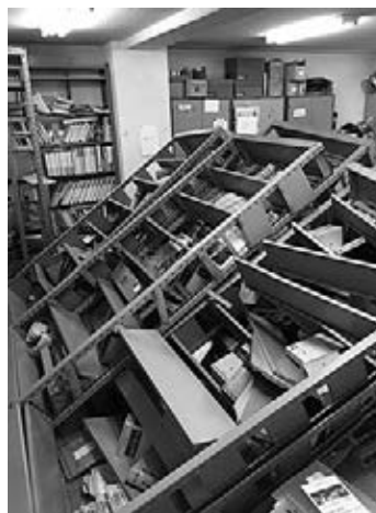
地震で倒壊した事務所の本棚
